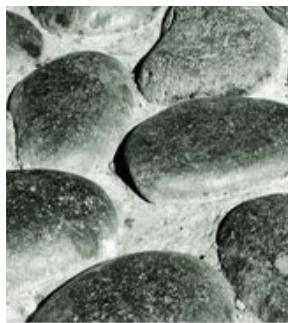
Figura 14: Bolón de piedra 10".
